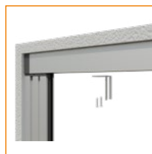
8. Fissare il fermo di battuta centrale all'interno della guida superiore
