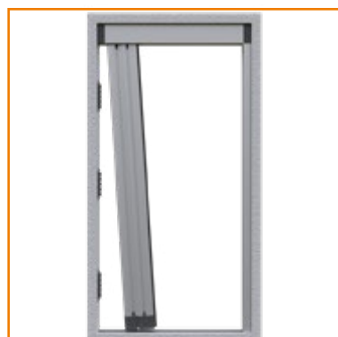
7. Inserire il corpo zanzariera nella guida superiore e farlo agganciare alle clips esercitando una leggera pressione. Attenzione! La parte superiore della zanzariera è quella con la dicitura UPSIDE sul tappo (vedi particolare 1)
