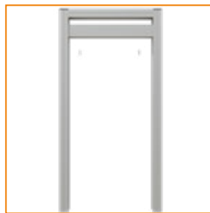
3. Fissare la guida superiore nella predisposizione incasso
