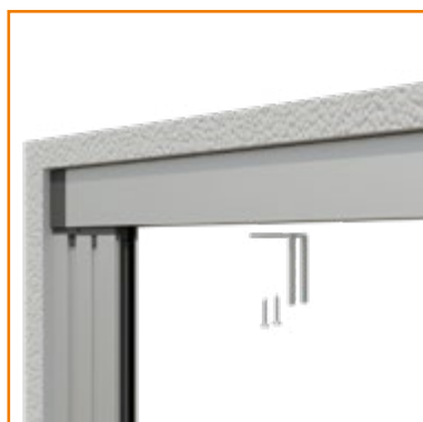
7. Fissare il fermo di battuta centrale all'interno della guida superiore
