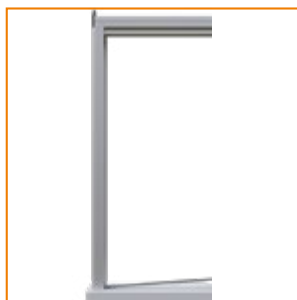
6. Posizionare la guida inferiore in pvc in linea con le clips. Incollare sfruttando il biadesivo presente sotto la guida
