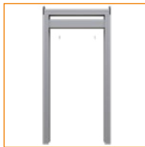
3. Fissare la guida superiore nella predisposizione monoblocco 85
