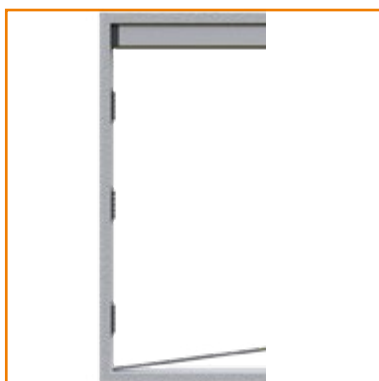
5. Posizionare la guida inferiore in pvc in linea con le clips. Incollare sfruttando il biadesivo presente sotto la guida
