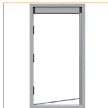
6. Posizionare la guida inferiore in pvc in linea con le clips e con il centro del riscontro magnetico. Incollare sfruttando il biadesivo presente sotto la guida
