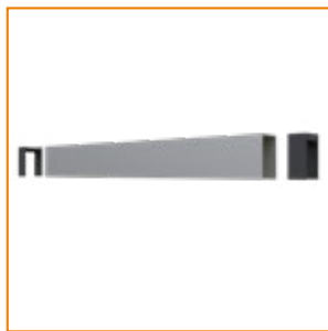
2. Inserire le cuffie telescopiche nella guida superiore
