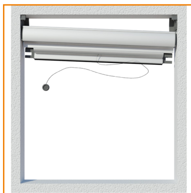
2. Inserire il corpo cassonetto nelle testate a muro esercitando una leggera pressione verso l'alto fino al completo aggancio
