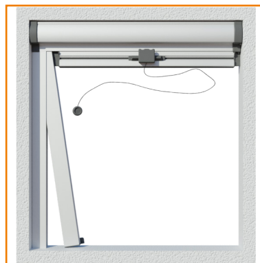
5. Inserire le guide spazzolino SX e DX all'interno delle guide registrabili con le alette dei ganci guida rivolte verso l'esterno (vedi particolare 2). In presenza di fuori squadra, effettuare le operazioni di registrazione delle guide spazzolino
