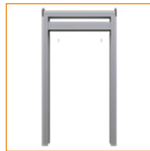
4. Fissare la guida superiore nella predisposizione monoblocco 85
