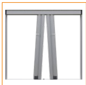
9. Inserire i corpi zanzariera nella guida superiore e farli agganciare fra di essi mediante le clips già posizionate su uno dei due corpi zanzariera, esercitando una leggera pressione (vedi particolare 2)
