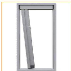
9. Inserire il corpo zanzariera nella guida superiore e farlo agganciare al riscontro con le clips esercitando una leggera pressione.
