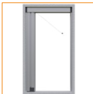
10. Eliminare il nastro blocca filo (vedi particolare 2) e inserire il nottolino aggancio filo nell'invito cuffia della guida superiore. Spingerlo verso l'alto (vedi particolare 3)
