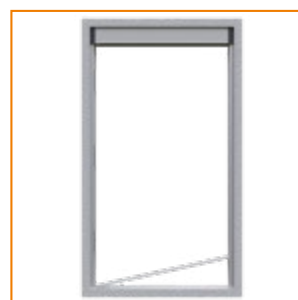
8. Posizionare la guida inferiore al centro dei riscontri. Incollare sfruttando il biadesivo presente sotto la guida
