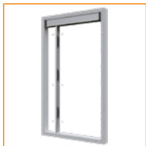
5. Fissare il riscontro con le clips sul vano dal lato in cui si vuole impacchettare la zanzariera
