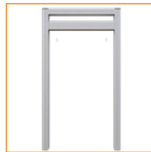
4. Fissare la guida superiore nella predisposizione incasso
