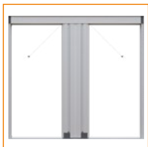
10. Eliminare i nastri blocca filo (vedi particolare 3) inserire i nottolini aggancio filo negli inviti cuffia della guida superiore. Spingerlo verso l'alto (vedi particolare 4)
