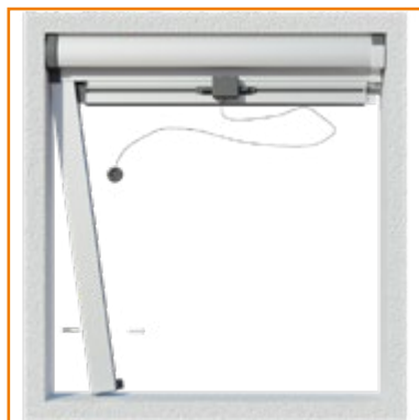
4. Inserire le guide spazzolino SX e DX all'interno della feritoia del cassonetto e nell'invito testata a muro (vedi particolare 1) con le alette dei ganci guida rivolte verso l'esterno (vedi particolare 2). Fissare al vano
