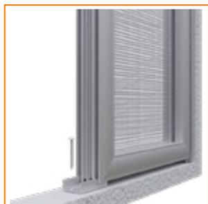
5. Spostare le ante su un lato del vano, inserire la guida centrale inferiore all'interno delle feritoie delle ante e fissare al centro della larghezza del vano
