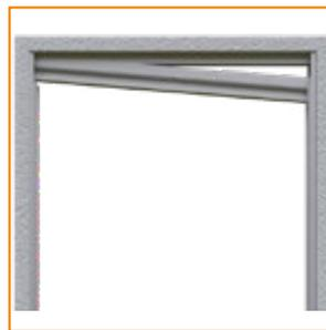
3. Inserire la guida superiore nella guida U di compensazione
