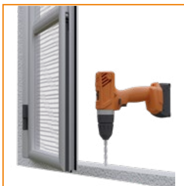
5. Forare la base del vano con una punta Ø 6 mm in direzione del catenacciolo
