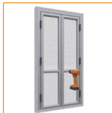
6. Forare il traverso con una punta Ø 5 mm per l'inserimento del pomello
