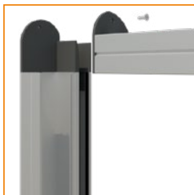
1. Fissare il profilo incasso superiore all'invito guida monoblocco 85
