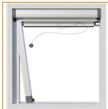
5. Inserire le guide bottoncino SX e DX all'interno delle guide registrabili con le alette dei ganci guida rivolte verso l'esterno (vedi particolare 2). In presenza di fuori squadra, effettuare le operazioni di registrazione delle guide bottoncino
