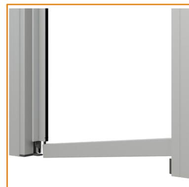
6. Inserire la guida bottoncino inferiore nella linguetta di collegamento guida e nel blocco guida del riscontro incasso magnetico facendo attenzione che l'invito guida in plastica sia rivolto verso il corpo cassonetto (vedi particolare 2).
