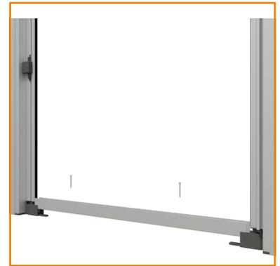
6. Inserire la guida registrabile inferiore all'interno delle feritoie degli innesti porta guida. Fissare al vano
