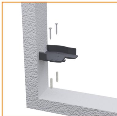
1. Fissare la testata a muro inferiore e superiore
