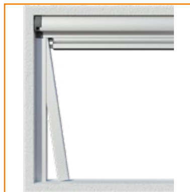
5. Inserire le guide bottoncino SX e DX all'interno delle guide registrabili con l'invito guida rivolto verso l'alto (vedi particolare 2). In presenza di fuori squadra, effettuare le operazioni di registrazione delle guide bottoncino
