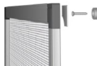
OPTIONAL: SISTEMA DI FISSAGGIO MAGNETICO
